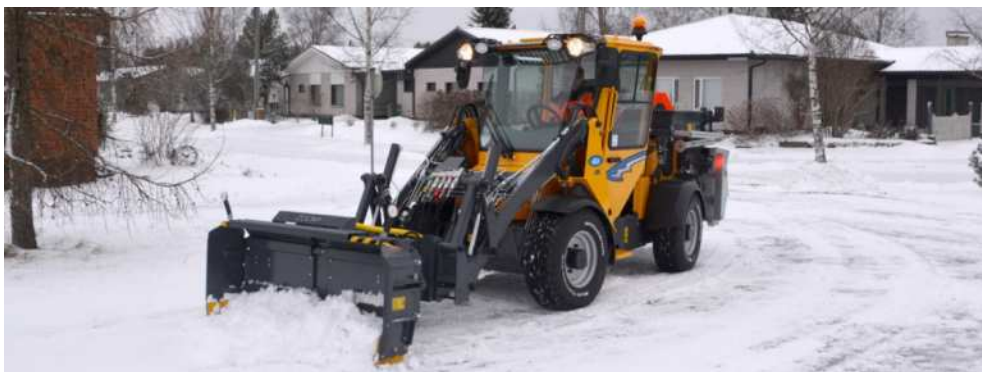
Utilaj multifuncțional dotat cu accesorii și echipamente pentru dezapezire și întreținere drumuri pe timp de vară.
