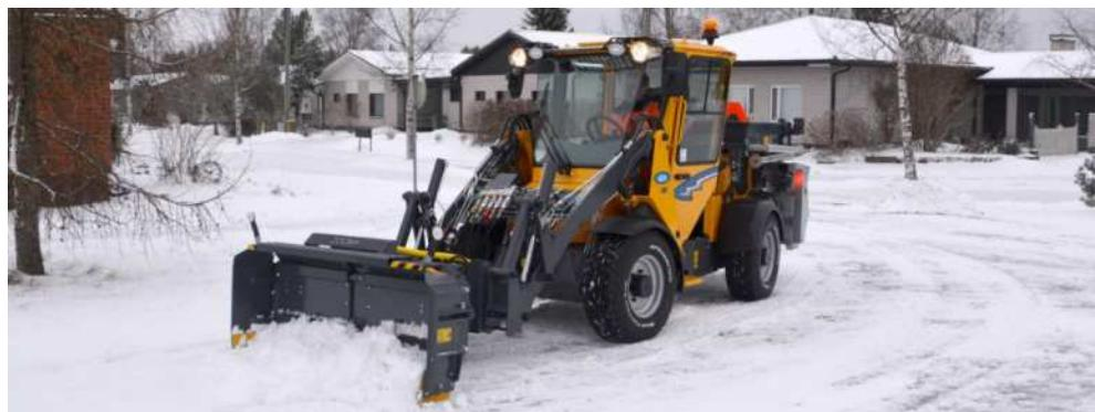
Multifunkcionalno vozilo opremljeno sa priborom i opremom za uklanjanje snega i održavanje puteva za vreme leta.
